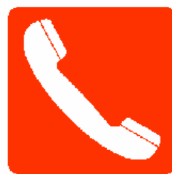
TELÉFONO PARA LA LUCHA CONTRA INCENDIOS
